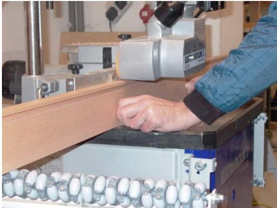
Het doorvoerapparaat voert het hout door
